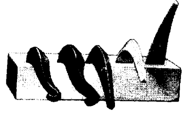
পাইরোমেট্রিক শঙ্কু : (ক) পোড়ানোর আগে ও (খ) পরে। ৪ সংখ্যক শঙ্কু পর্যাপ্ত পোড়ানো হয়েছে।
